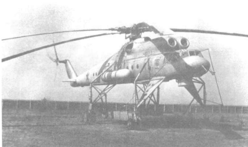
базе Ми-6 с максимальным использованием его агрегатов, в том числе силовой установки, несущего и рулевого винтов, трансмиссии. Заимствовались схемы управления вертолета и гидравлическая система с изменениями, касающимися управления гидрозавхватами.
